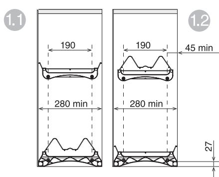
2. Установить крепежные планки для кружек (d) в шкаф (модуль), используя саморезы (g).
